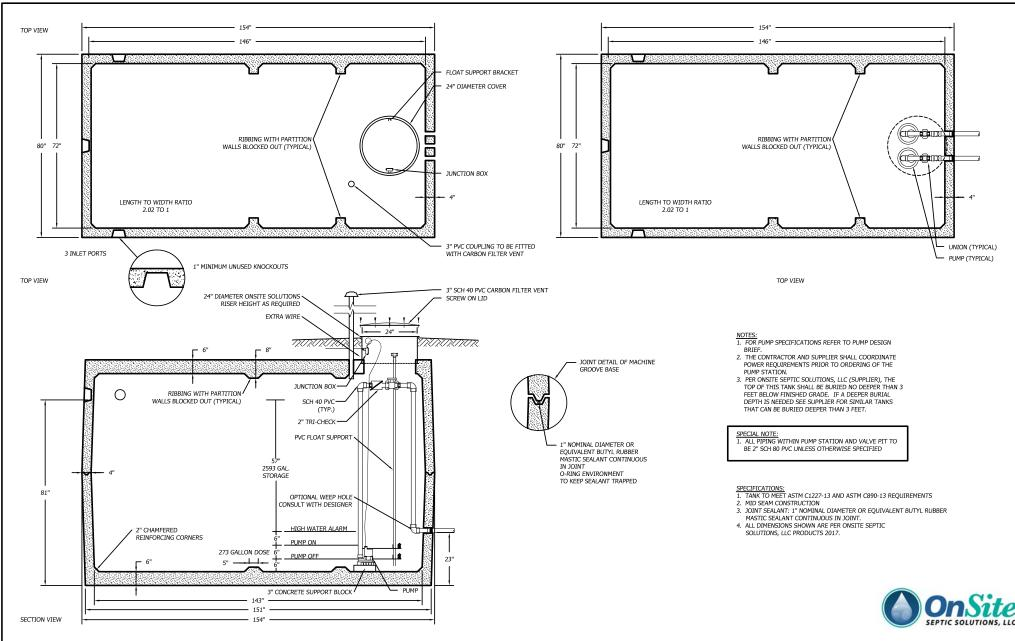
3,000 GALLON MID SEAM 6" TOP & BOTTOM PRECAST CONCRETE HEAVY DUTY DUPLEX PUMP STATION
